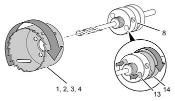
3. Mettez en regard les trous de blocage (12) du trépan et les goujons (13) de l'adaptateur (8). Au besoin, dévissez un peu le trépan.
